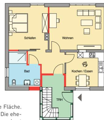
Wohn- und Essraum bildeten bisher eine geräumige Fläche. Nach dem Umbau entstanden hieraus zwei Zimmer. Die ehemalige Vorratskammer wurde zum Treppenhaus ausgebaut und das Bad vergrößert. Die frühere innenliegende Treppe verschwand komplett.
