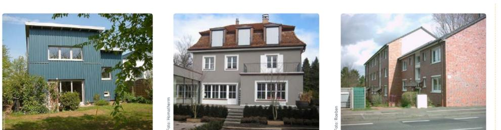
Hier wurde nachträglich von außen gedämmt. Als Fassade ist eine Bodendeckelschalung montiert mit einer Holzschutzfarbe aus Norwegen im Farbton Fjordblau.
